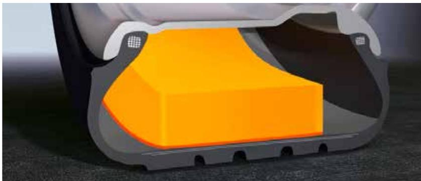
Una speciale schiuma di poliuretano, fissata alla superficie interna del battistrada dello pneumatico, attutisce le asperità della strada, assorbendo fino a 9 dB(A) le componenti particolarmente fastidiose del rumore di rotolamento percepite all'interno del veicolo. Il livello esatto di riduzione dipende dal tipo di veicolo, dalla velocità e dalla superficie stradale.
