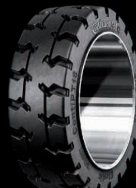
Il ContiPT18 è una copertura Press-On-Band che possiede l'eccellente forza motrice di una copertura Super Elastic. Con il suo speciale battistrada tassellato, ideale per superfici irregolari e bagnate, assicura la migliore trazione possibile, oltre a maggiore resa chilometrica e sicurezza.
