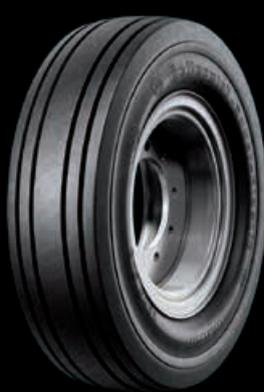
La copertura SC11 offre un'elevata stabilità di guida grazie al battistrada. Inoltre, il battistrada chiuso ed uniforme fornisce una migliore risposta in fase di sterzo ed eccellente stabilità in curva.
