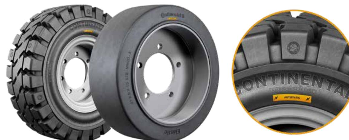
Ogni veicolo si carica di elettricità statica durante la guida, perché le gomme tradizionali non hanno praticamente alcuna proprietà conduttiva. Tuttavia, in aree d'impiego sensibili all'elettricità, scariche elettriche non controllate potrebbero provocare scintille pericolose. Per questo, abbiamo sviluppato versioni delle nostre gomme super elastiche SC20 e MH20 con speciali capacità antistatiche in grado di prevenire questo fenomeno.
