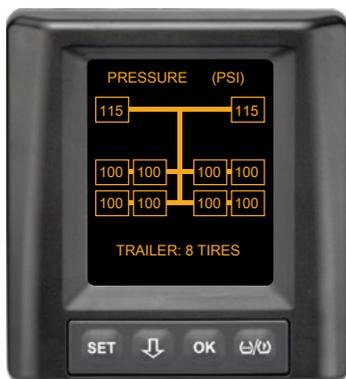
Ta zaslon se prikaže, ko pogoji za samodejno zaznavo priklopnika s položajem pnevmatik niso izpolnjeni, pri čemer so vrednosti polnilnega tlaka in temperature v pnevmatikah znotraj dovoljenega območja vrednosti.
