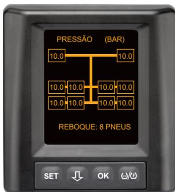
A indicação surge se não estiverem preenchidas as condições para o reconhecimento automático do reboque com posição do pneu e se os valores da pressão de enchimento e as temperaturas no interior dos pneus se situarem dentro da faixa de valores permitida.
