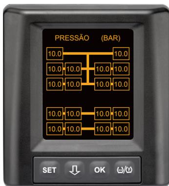
A indicação surge quando estiverem preenchidas as condições para o reconhecimento automático do reboque com posição do pneu. Os valores dos pneus do reboque são indicados individualmente com a posição. A sua representação corresponde à dos pneus do camião.
